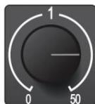
Kontrola ulaznog pojačanja. Ovi gumbi daju 50 dB promjenjivog pojačanja (0 do +50 dB za mikrofone, -15 do 35 dB za liniju/instrument).
